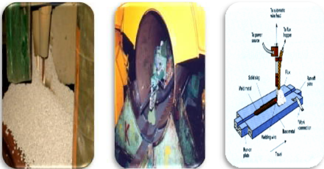
شکل ۳-۴ جوش زیر پودری، داخلی و بیرونی لوله
