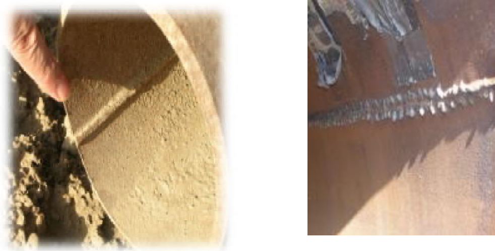
شکل ۲۶-۴ برداشت ناقص زائده جوش
