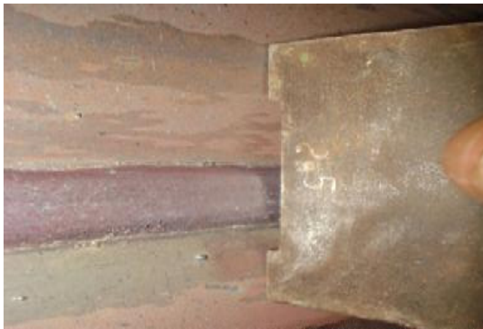
شکل ۱۸ - ۴ عدم تراز لبه‌های جوش
