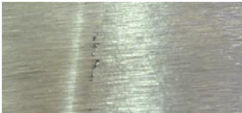
شکل ۱۶-۴ ذوب ناقص بین فلز پایه و جوش
