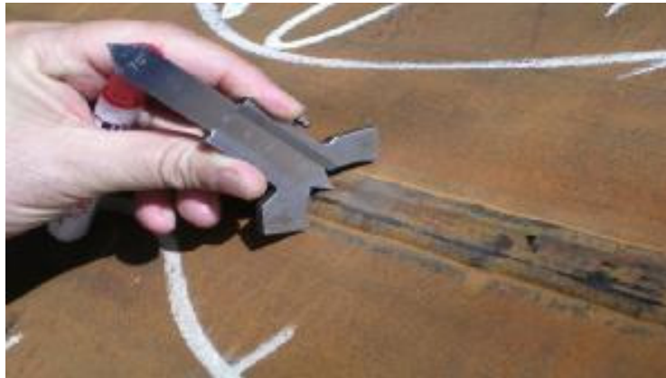
شکل ۱۵-۴ اندازه‌گیری ارتفاع جوش
