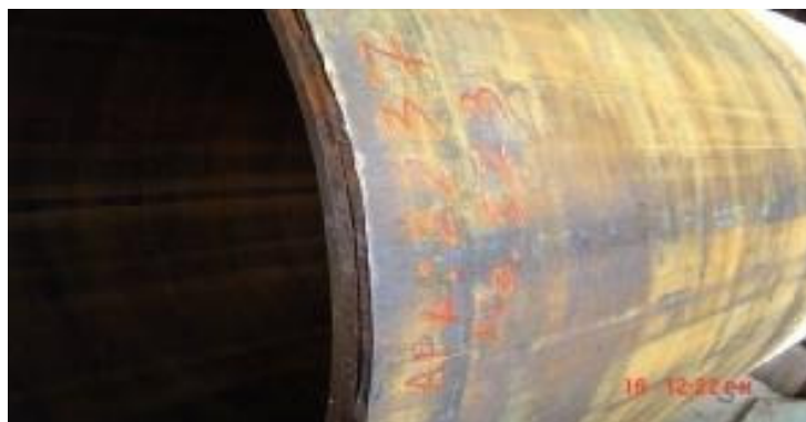
شکل ۳-۴ دو پوستگی بر اثر محبوس شدن هوا
