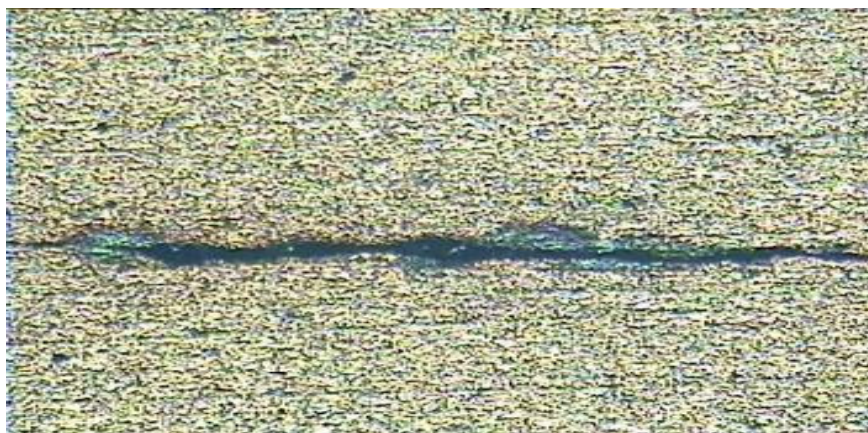
شکل ۴-۴ دو پوستگی بر اثر تجمع ذرات ناخالصی
