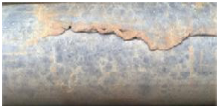
شکل ۹-۴ چروک خوردن بدنه لوله
